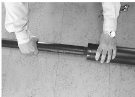
Kuva 3: Putken liittäminen sylinterin yläosaan
