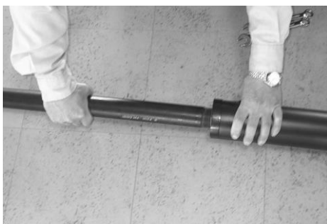
Kuva 4: Putken liittäminen sylinterin yläosaan
